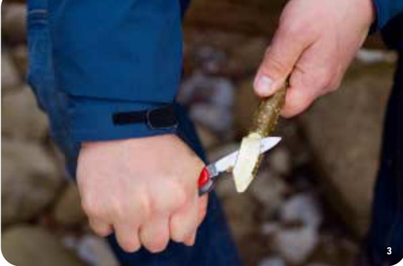
Man sollte das Messer nicht zu weit hinten am Griff fassen, denn dadurch verliert man an Schnittkraft. Wenn nur noch ein kleines Stück der Griffschalen aus der Faust herauschaut, halten Sie das Messer korrekt (1).
