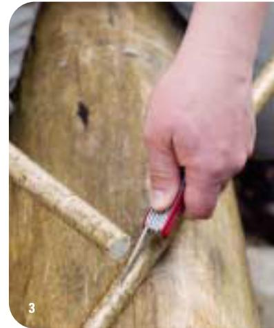
Die Achse spalten Sie mittig auf einer Strecke von 15–20 cm der Länge nach auf. Dabei legen Sie die Klinge in der Mitte auf das Holz und schlagen sie mit einem Aststück durch, bis die Klingenspitze auf der gegenüberliegenden Seite herauschaut (3). Danach stellen
