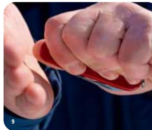
**Einklappen:** Halten Sie das Messer, wie beim Aufklappen beschrieben (6). Befördern Sie mit der Handfläche der anderen Hand die Klinge zurück ins Gehäuse (7, 8, 9). Achten Sie darauf, dass kein Teil des Handballens von der einzuklappenden Klinge eingeklemmt wird. Ob Sie Rechts- oder Linkshänder sind, spielt keine Rolle. Probieren Sie selbst aus, wie es sich für Sie besser anfühlt.
