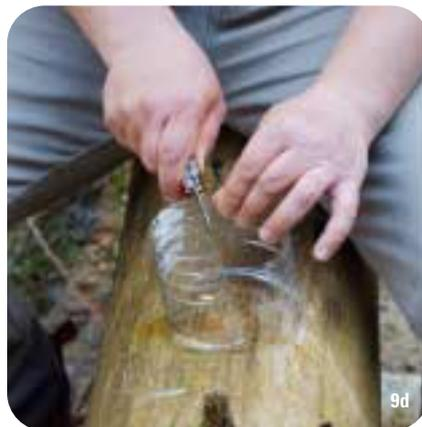
Schneiden Sie nun aus der PET-Flasche vier möglichst gleichgroße Schaufeln (9a–d). Mit der Ahle treiben Sie in jede Ecke der Schaufeln ein Loch (10). Die Löcher dürfen wegen der Gefahr des Ausreißens nicht zu nahe an den Rand gesetzt werden. Alternativ zur Ahle können die Löcher auch mit einem glühenden Nagel oder einem Locheisen gefertigt werden.
