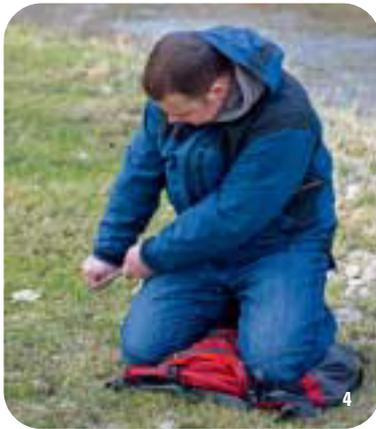
oberhalb des Knies abgestützt. Das verleiht beim Halten des Werkstücks mehr Stabilität. Die Hand, die das Holz festhält, befindet sich immer hinter dem Messer – auf gar keinen Fall davor. Die Schnitzbewegung erfolgt gegen den Boden. Der Auslauf der Messerbewegung muss ins Leere gehen. Wichtig: Nie gegen die Oberschenkel im Bereich von Schoß und Leisten schneiden! Hier verlaufen wichtige Blutbahnen. Der Schnitzbereich liegt immer vor den Knien.
